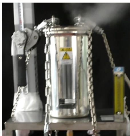
図 7. 1. 3-10 試験②-No. 2 の破裂時に観測された煙の写真
