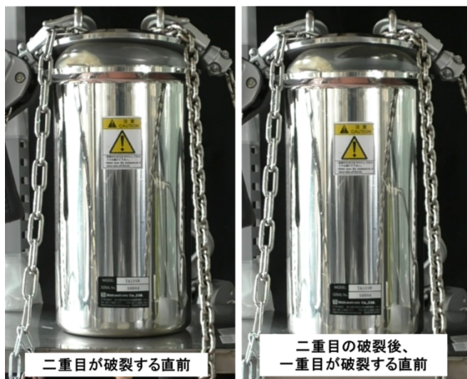
図 7. 1. 3-8 試験②-No. 3 の破裂直前の写真
